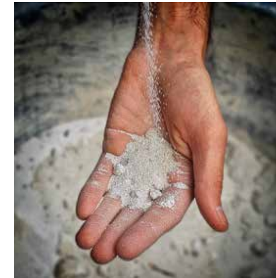
Struvit aus dem Klärwerk Steinhof.
